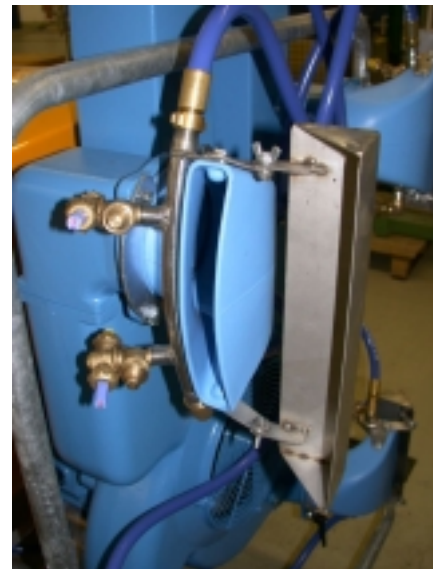
Abb. 5: Luftdüse mit Zerstäubern (Doppeldüsenkörper mit Membranventil)
