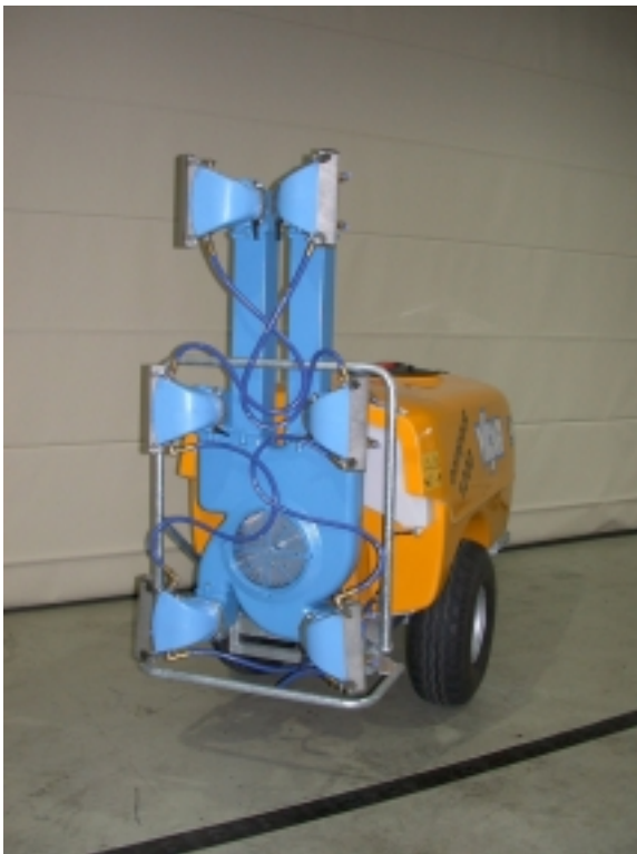
Abb. 4: Radialgebläse mit 6 Luftdüsen (schwenkbar)
